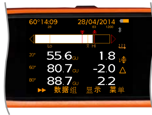
自动重复模式显示柱状图和读数与差值
