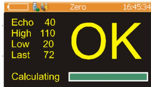
**Hinweis:** Im unwahrscheinlichen Falle einer Fehlkalibrierung wird ein Fehlercode im Display angezeigt. Prüfen Sie den Kalibrierblock auf Beschädigungen und Verschmutzungen und wiederholen die Nullung. Sollte mehrfach eine Fehlermeldung erscheinen, wenden Sie sich bitte an Elcometer.
