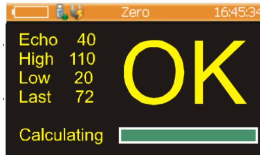
**Opmerken:** In het onwaarschijnlijke geval dat er zich een nulstellingsfout voordoet, zal een foutcode worden weergegeven. Controleer het nulstellingsblok op verontreiniging of beschadiging en probeer het nogmaals. Neem contact op met de dichtstbijzijnde Elcometer-vertegenwoordiger als er zich meerder fouten voordoen.
