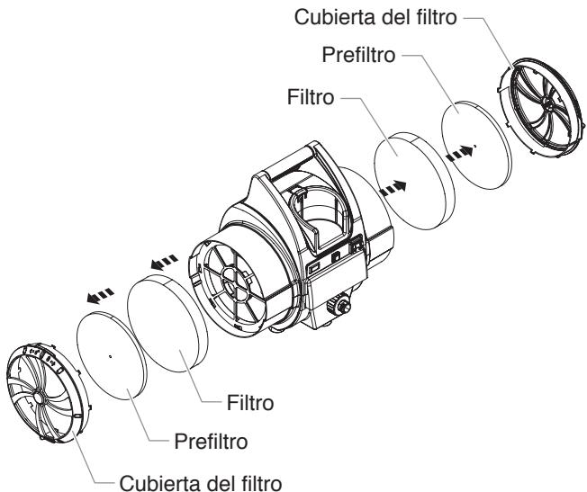
3. Limpie los filtros. Puede sacudir los filtros para sacar los contaminantes o usar aire comprimido para sopletear los contaminantes. Para material pegado difícil de separar, sumerja los filtros en agua jabonosa o espíritus minerales. Permita que los filtros se sequen completamente antes de volverlos a colocar en la turbina.
