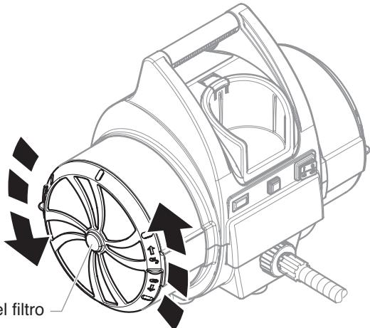
2. Retire cada conjunto de filtro (prefiltro y filtro), de la carcasa del filtro a cada lado de la turbina.
